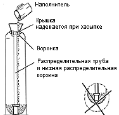
Рис. 3. Монтаж распределительной трубы в корпусе установки.
