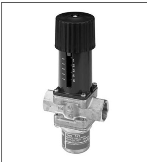
FJV – регулятор температуры прямого действия, предназначенный для ограничения температуры теплоносителя, возвращаемого в систему централизованного теплоснабжения после теплоиспользующих аппаратов. Клапан регулятора закрывается при превышении установленной величины температуры.
