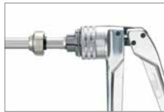
Рис. 13-6 Развальцовка конечного участка трубки
