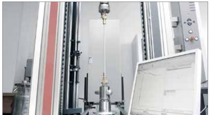
Рис. 3-3 Ход испытания на растяжение
