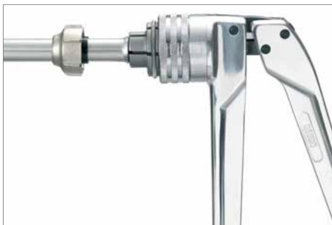
Рис. 13-2 Развальцовка конечного участка трубки
