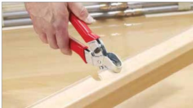
Рис.16-46 Вырезка полукруглых отверстий в крышке плинтусного канала
